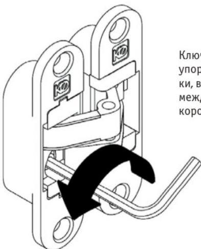
Ключом на 6 мм, повернуть до упора, против часовой стрелки, винт, регулирующий зазор между дверным полотном и коробом.
