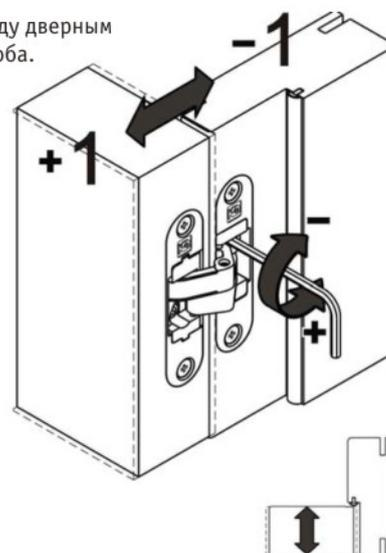
Регулировка зазора между дверным полотном и стойкой короба.
