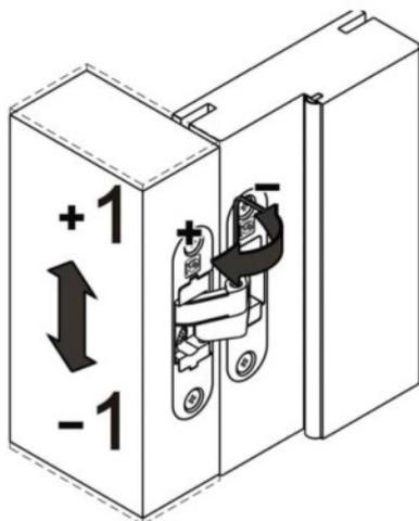
Регулировка зазора между дверным полотном и стойкой короба.
