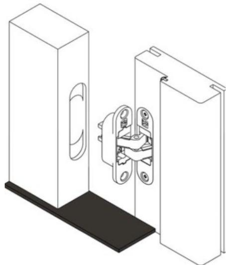
Придвинуть дверное полотно, установить в него петли, закрепив каждую саморезами с потайной головкой.
