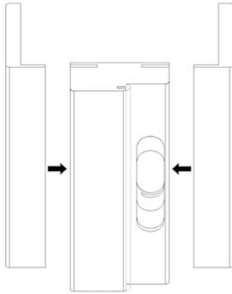
В местах, предназначенных для установки петель отметьте на крыле наличника ту его часть, которую нужно удалить.
