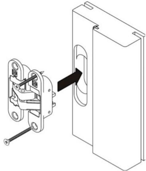
Установить дверное полотно на планку толщиной 10 мм так, как указано на рисунке.
