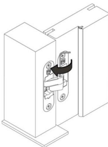
Винт регулировки повернуть по часовой стрелке до появления сопротивления. После появления сопротивления сделать еще один оборот винта.
