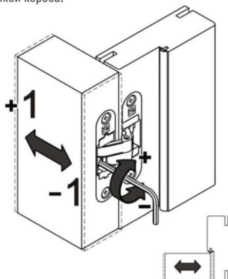
Регулировка вертикальности дверного полотна.
